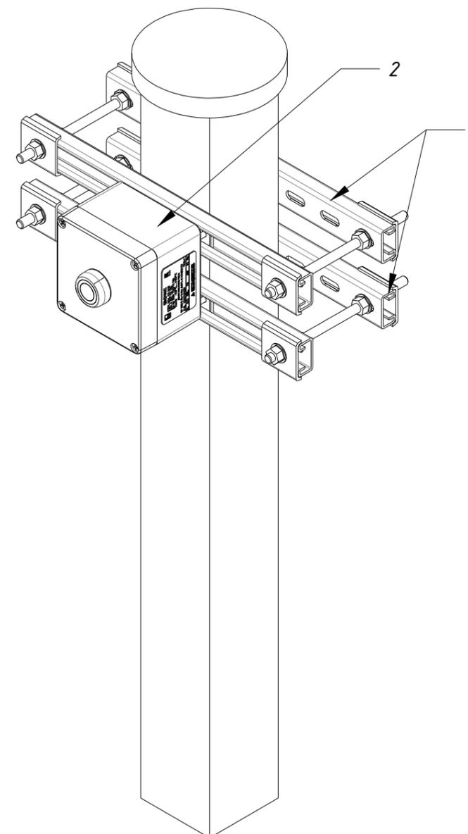
1. Комплект Ex-tr0403HDZ позволяет регулировать расположение взрывозащищенного электрооборудования по высоте.
