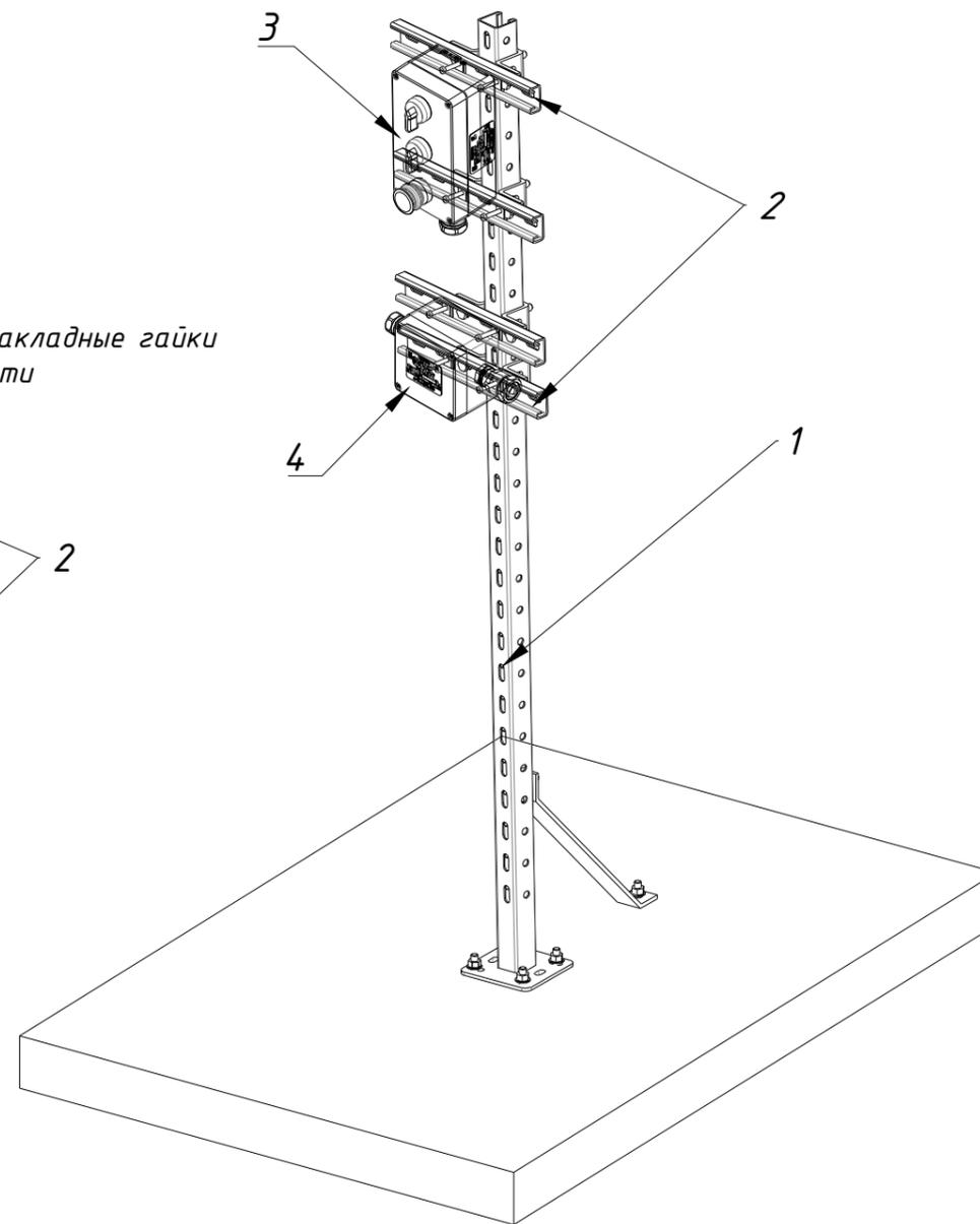
1. Стойка Ex-st15 позволяет регулировать расположение взрывозащищенного электрооборудования по высоте.
